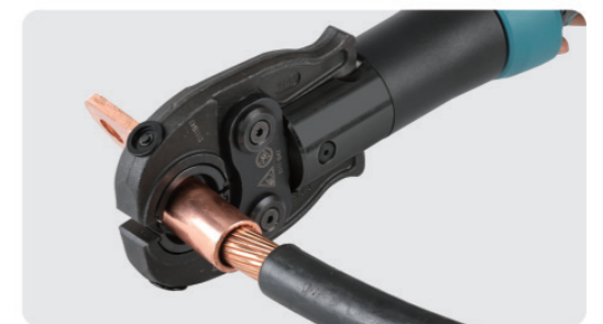
Cu 300mm 2 (suit for Tubular lugs)
